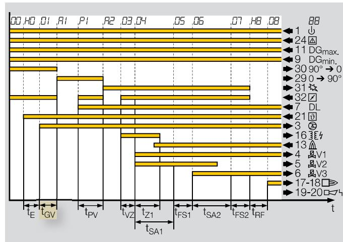
Параметр определяет время между подачей сигнала включения на вентилятор (клемма 3) и началом открытия заслонки или пуском горелки. Запуск вентилятора при закрытой дроссельной заслонке сокращает пусковой ток двигателя.
