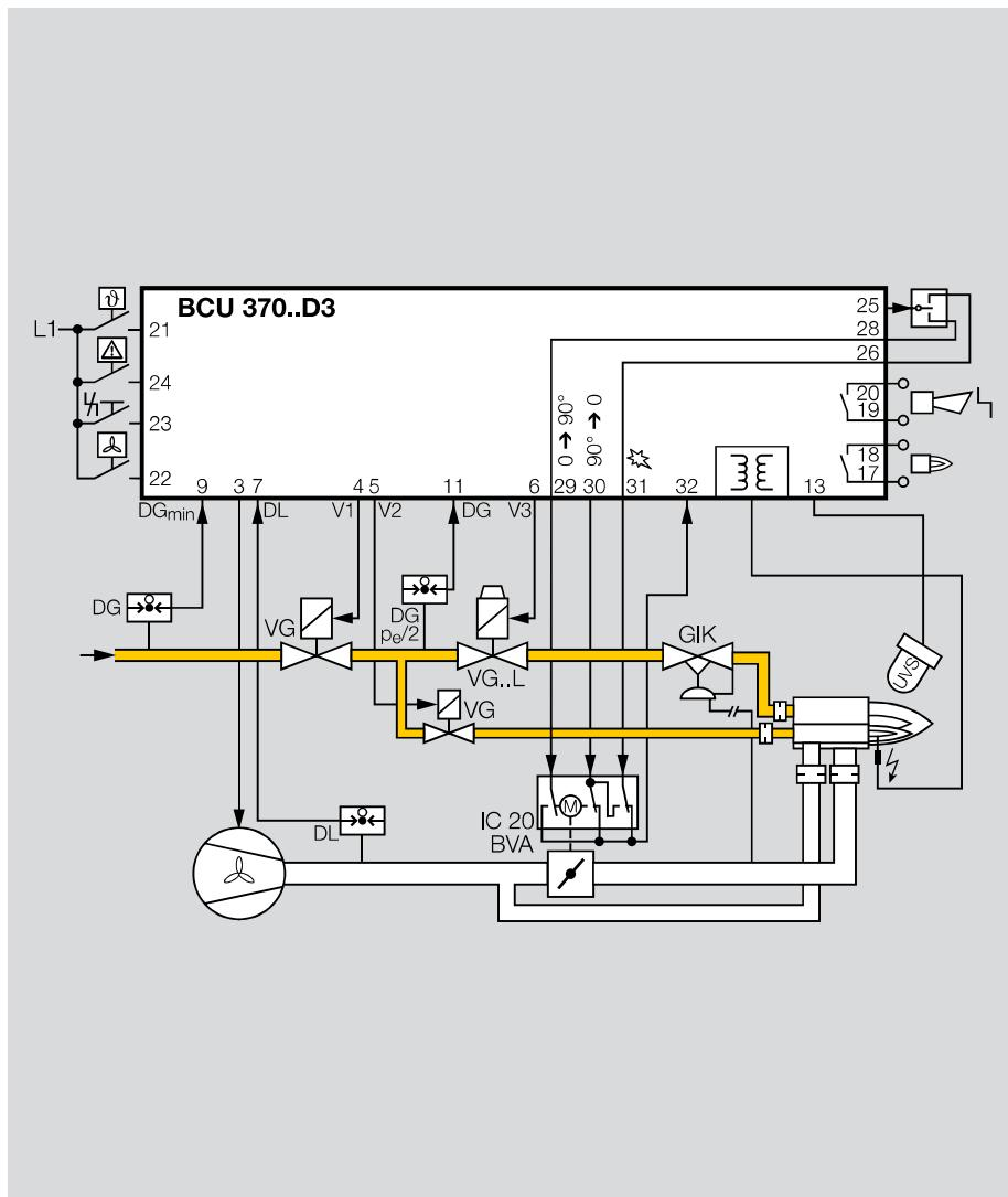
Газопровод за ближним к горелке газовым электромагнитным клапаном V2 не должен быть перекрыт, чтобы пространство между клапанами V1 и V2 могло вентилироваться. Датчик давления DG контролирует давление между обоими клапанами. Он должен настраиваться на значение  $P_e/2$ , чтобы испытывать оба клапана с одинаковой точностью. У горелок, оснащенных запальной горелкой и 3 газовыми электромагнитными клапанами, испытание клапанов V2 и V3 происходит одновременно.
