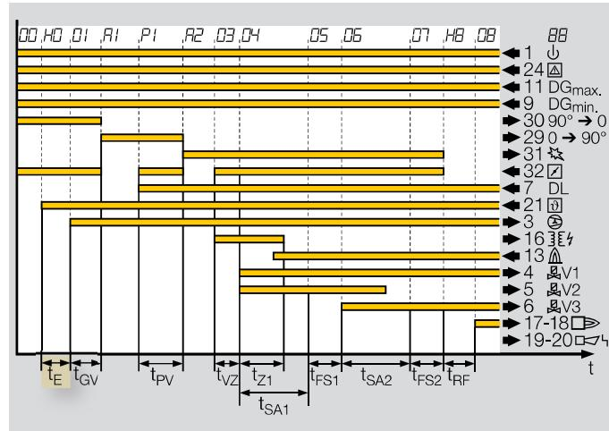
Устанавливает промежуток времени между подачей сигнала регулирования ( $\vartheta$ ) и началом запуска горелки. При нескольких одновременно управляемых горелках, по-разному установленное время задержки пуска  $t_E$ , предотвращает одновременный запуск вентиляторов и уменьшает нагрузку в электрической сети.
