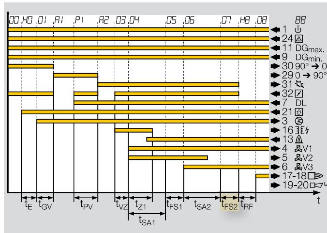
Время стабилизации пламени устанавливается в зависимости от комбинации запальной и основной горелок. Это время даёт возможность застабилизироваться факелу горелки, прежде чем BCU начнёт выполнять следующий шаг программы. Время стабилизации пламени  $t_{FS2}$  следует за временем безопасности  $t_{SA2}$ .
