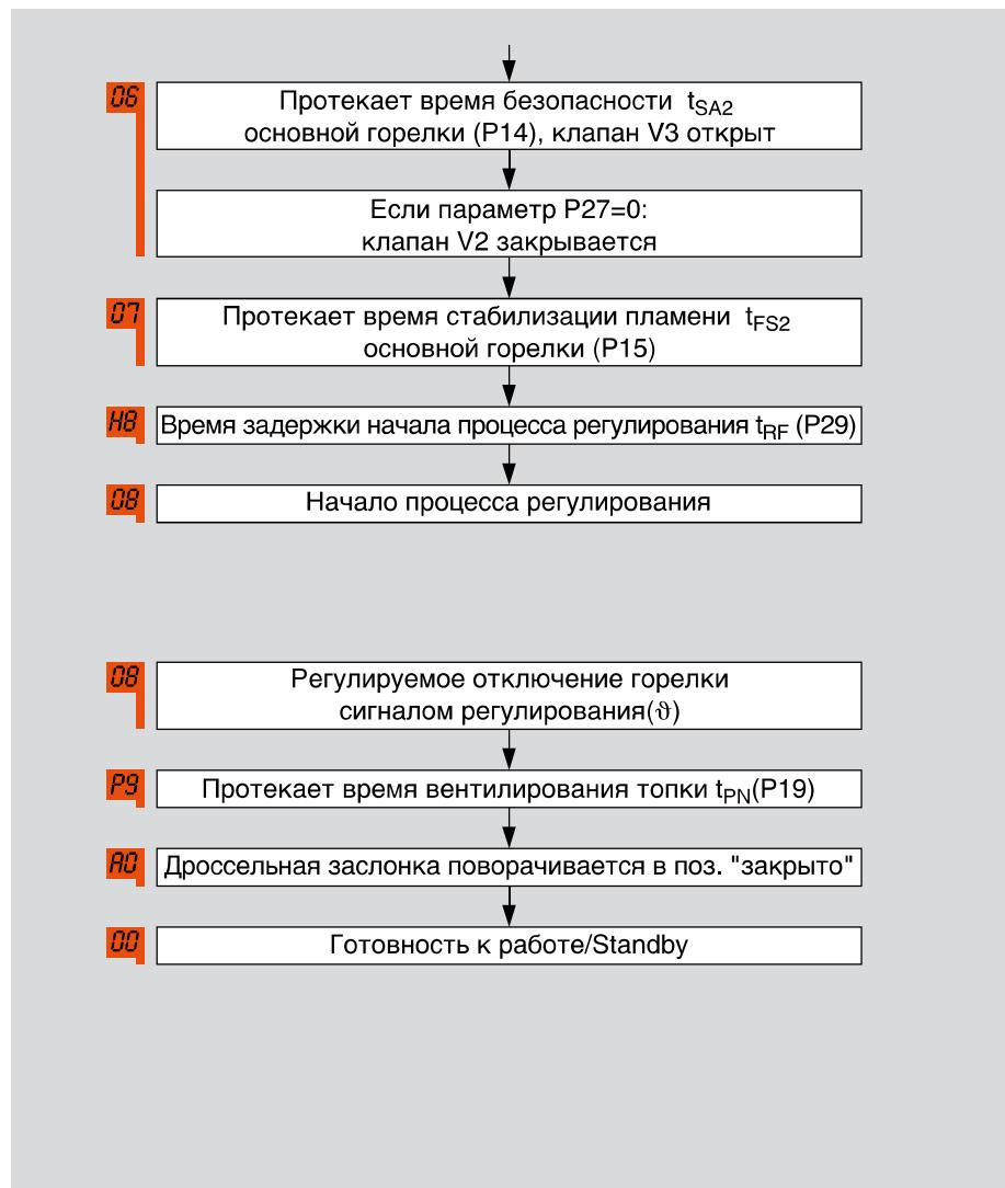
Шаги программы 06 и 07 также отсутствуют, если основная горелка не имеет запальной горелки. Как только выключается сигнал управления ( $\theta$ ), начинается вентилирование топки. Дроссельная заслонка поворачивается в позицию «розжиг», а затем позицию «закрыто». После этого BCU остается в положении Готовность к работе/Standby.
