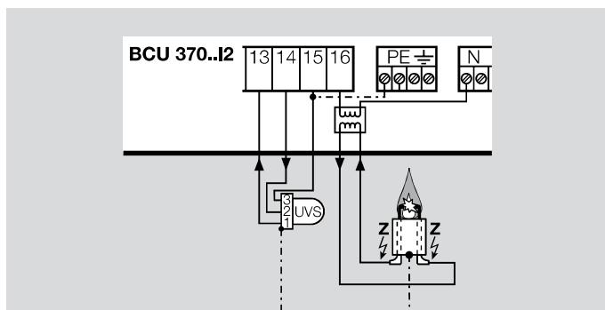
BCU 370..I2 для 230 В с искрообразованием между двумя электродами
