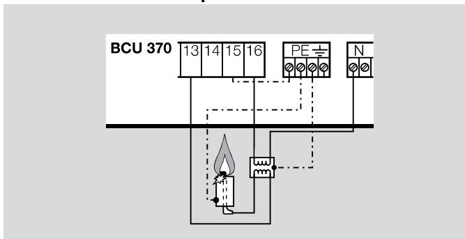
Если горелка оснащена только одним электродом, для розжига и контроля пламени, то необходимо использовать внешний запальный трансформатор, например, TZI или TGI.
