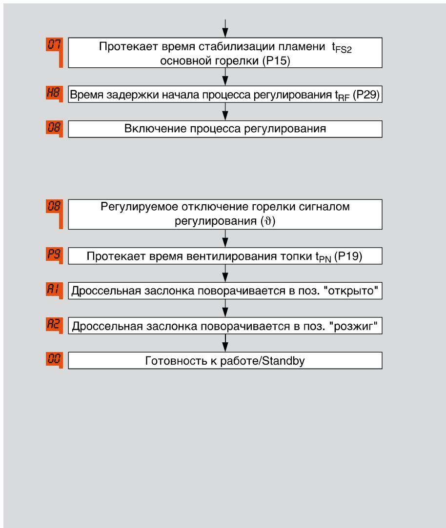
После регулируемого отключения горелки происходит вентилирование топки  $t_{PN}$ . Дроссельная заслонка поворачивается в позицию «розжиг», чтобы быть готовой к следующему пуску.
