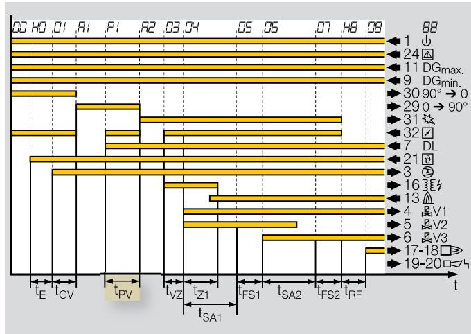
Устанавливает временной промежуток, во время которого перед розжигом горелки воздух поступает в камеру сгорания.
