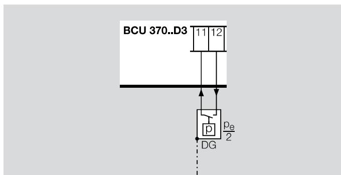
BCU 370..D3 с датчиком давления газа DG для
