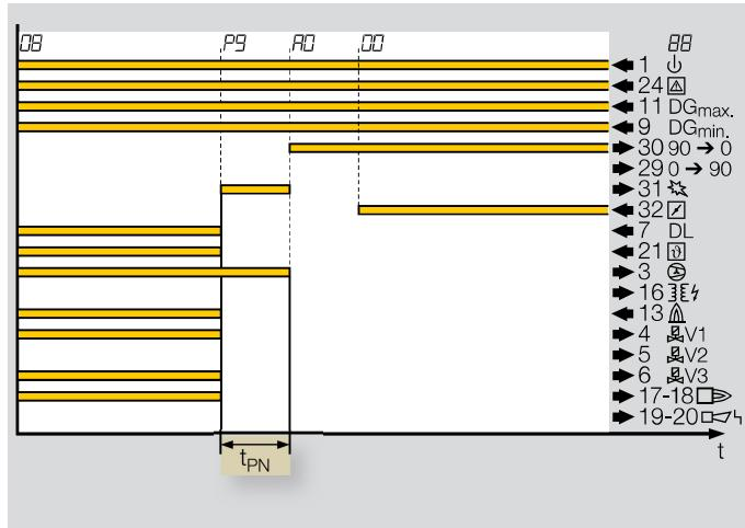
Устанавливает временной промежуток, во время которого после выключения горелки воздух продолжает поступать в камеру сгорания.
