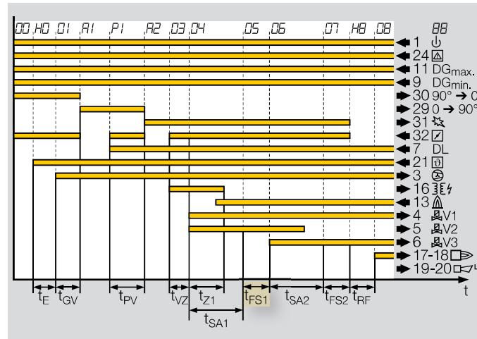
Можно установить время стабилизации пламени горелки или запальной горелки.
