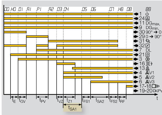
Время безопасности при пуске  $t_{SA1}$  определяет, по истечении какого периода газовые клапаны запальной горелки или горелки должны закрыться при отсутствии сигнала наличия пламени.
