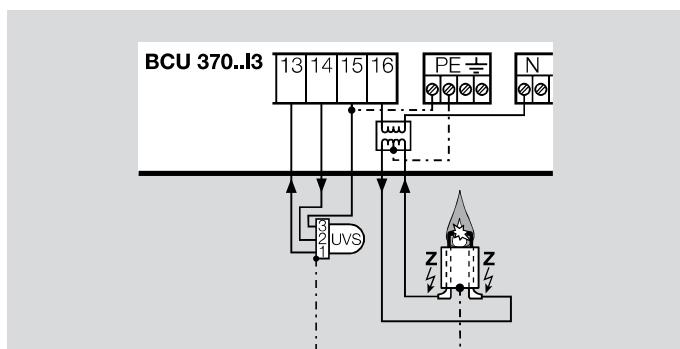
BCU 370..I3 для 120 В с искрообразованием между двумя электродами с заземлением средней точки вторичной обмотки трансформатора
