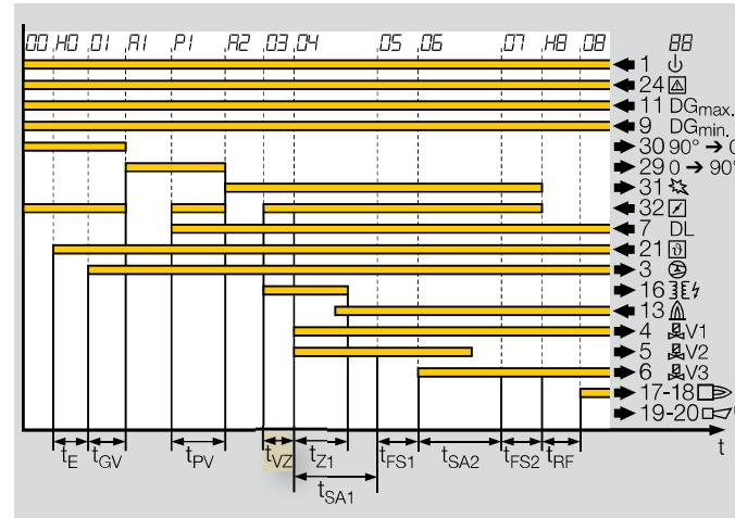
Включается электроискровое устройство розжига. В течение времени задержки зажигания  $t_{VZ}$  искра может стабилизироваться в воздушном потоке. Газовые клапаны в течение времени задержки зажигания  $t_{VZ}$  еще закрыты. После истечения времени задержки зажигания  $t_{VZ}$  включается время безопасности  $t_{SA1}$ . Клапаны открываются и электроискровое устройство розжига продолжает работать (подавать искру).
