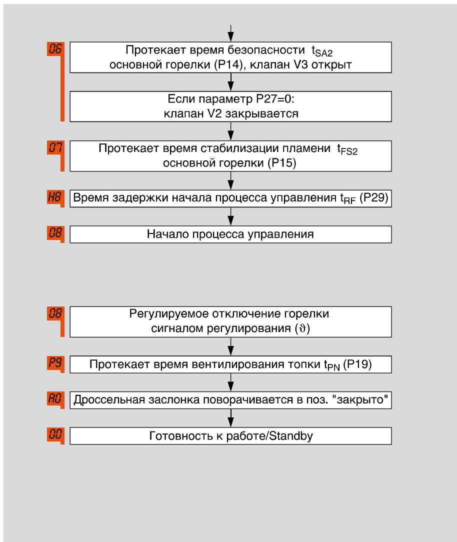
Далее BCU включает электроискровое устройство розжига TFZ и затем открывает клапан основной горелки V1 и клапан запальной горелки V2. Время розжига  $t_Z$  постоянно. По истечении времени стабилизации пламени запальной горелки  $t_{FS1}$  открывается клапан V3 для запуска основной горелки.
