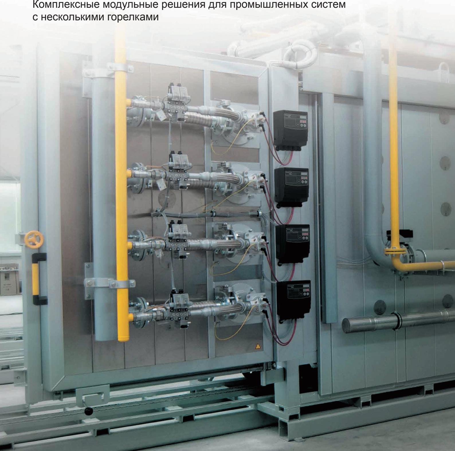
Блоки управления следующего поколения Honeywell Kromschröder® серии BCU 4, включая модели BCU 460, 465 и 480, имеют одноблочную конструкцию, позволяющую выполнять установку рядом с промышленными горелками, что облегчает интеграцию в систему и обеспечивает высокую экономическую эффективность.
