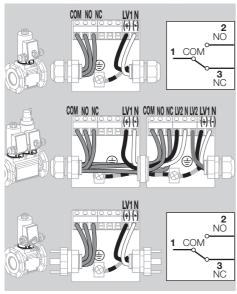
Запорный сдвоенный клапан: при встроенном штекере с разъемом возможно подключение только одного указателя положения.
