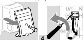
→ Если подключен указатель положения, его также следует отключить.
