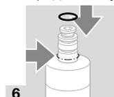
→ Если у прибора на месте, указанном стрелкой, имеется O-кольцо, замените привод описанным здесь способом: VAS 1: используйте все уплотнения из адаптерного комплекта для привода. VAS 2, VAS 3: используйте маленькое и только одно большое уплотнение из адаптерного комплекта для привода.
