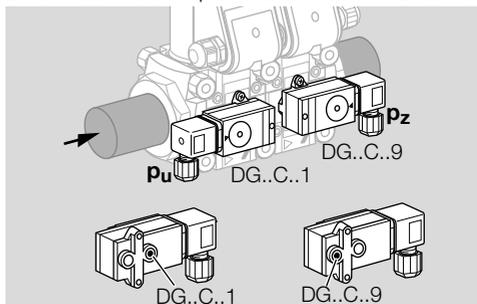
→ При дооснащении датчиком-реле давления газа см. приложенное Руководство по эксплуатации «Датчик-реле давления газа DG..C», раздел «Монтаж DG..C.. на запорном клапане valVario».
