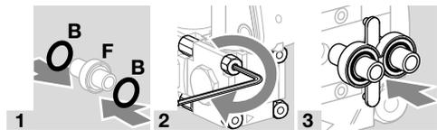
4 Снимите заглушку с монтажной стороны байпасного клапана.
