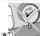
**6** Откройте байпасный или газовый клапан запальной горелки.
