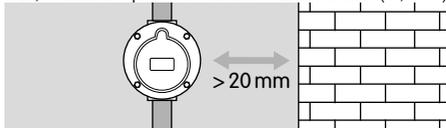
→ При монтаже на открытом воздухе рекомендуется защитная лакировка.
