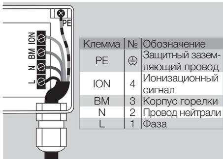
Схемы электроподключения автоматов управления горелкой
