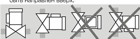
→ Запорный моторный клапан VK не должен касаться стены. Минимальное расстояние 20 мм в сторону.
