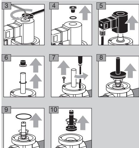
▷ Проверьте запирающую пружину на предмет повреждений.
