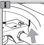
**18** Присоедините импульсную линию и трубопровод сапуна.
