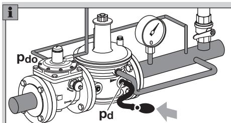
▷ При достижении заданного давления срабатывания  $p_{do}$  JSAV закрывается. Видно четко красное обозначение «SHUT».
