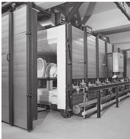
Печь для обработки керамики с импульсной системой управления
