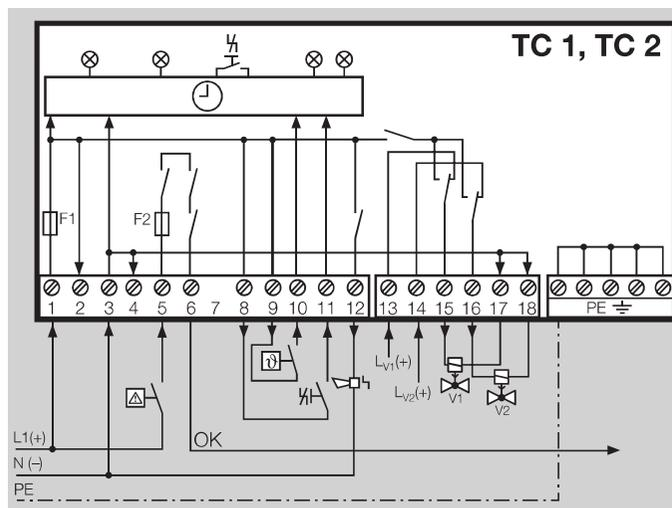
V1 = входной клапан, V2 = выходной клапан.
