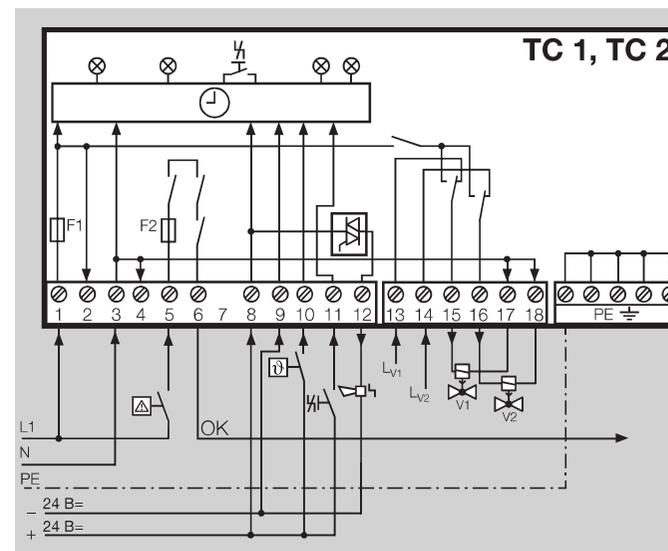
V1 = входной клапан, V2 = выходной клапан.
