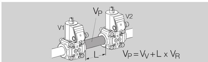
Для автомата контроля герметичности ТС требуется минимальная пусковая нагрузка для проведения проверки герметичности на медленно открывающихся клапанах, см. стр. 38 (Рекомендации по проектированию).
