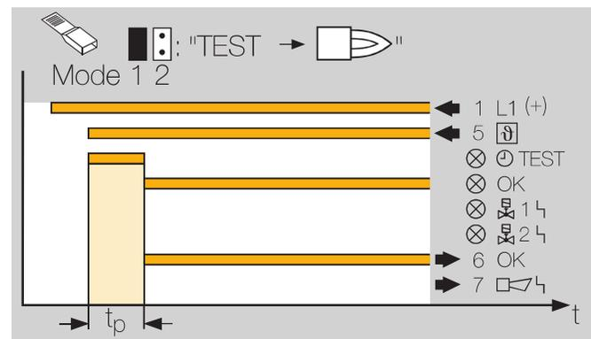
Если автомат контроля герметичности ТС обнаруживает утечку на одном из двух клапанов, загорается красный светодиод аварии  $\text{ⓧ}^1$  на клапане V1 или  $\text{ⓧ}^2$  на клапане V2. О неисправности оповещается внешне  $\text{ⓧ}$ , например, путем включения звукового сигнала или сигнальной лампы.
