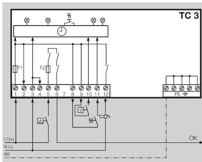
При подаче напряжения питания на клемму 11 или на «сухие» контакты между клеммами 11 и 12 происходит дистанционная деблокировка.
