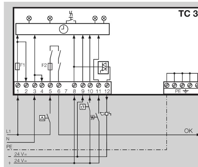
При подаче управляющего напряжения (+ 24 В) на клемму 11 происходит дистанционная деблокировка.
