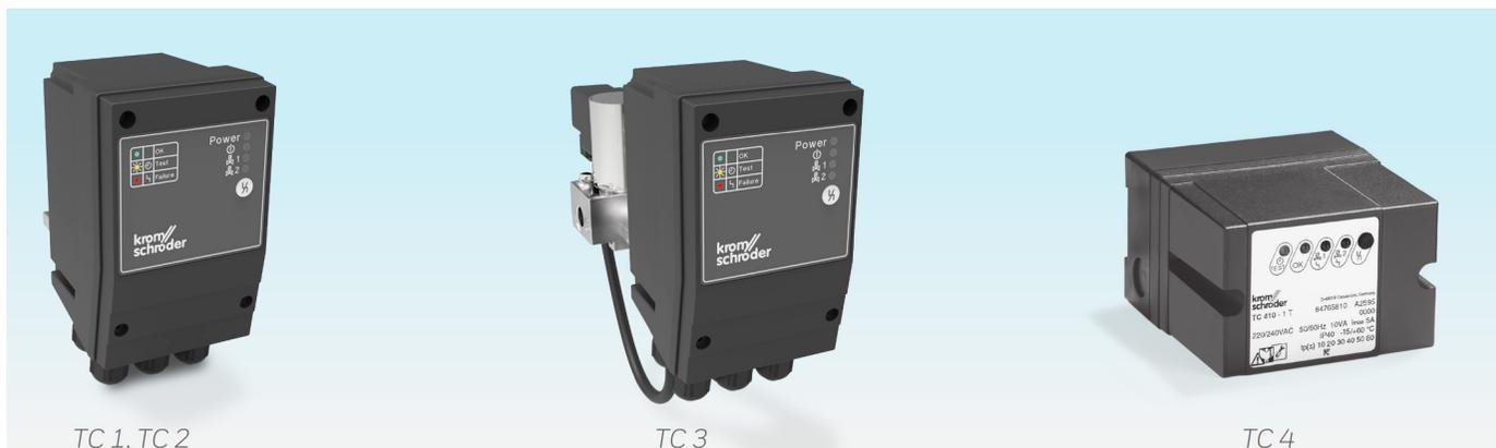
Автомат контроля герметичности ТС осуществляет проверку герметичности запорных газовых клапанов перед каждым пуском или после каждого выключения установки с двумя запорными клапанами.
