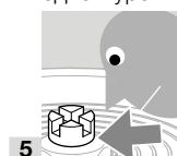
→ Электромагнитный привод с муфтой сцепления слегка сместите (около 10°) при установке относительно соединительного захвата дискового затвора.
