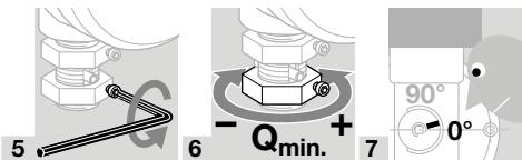
**8** После успешно проведенной настройки снова прикрутите оба регулировочных винта для  $Q_{\min}$ . и  $Q_{\max}$ .
