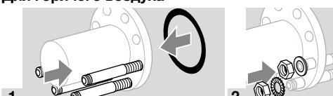
→ Следите за тем, чтобы обе зубчатые шайбы были смонтированы на одном и том же винте.
