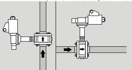
→ Для дисковых затворов с ограничителями рекомендуется установка на вертикальном трубопроводе с направлением потока снизу вверх, чтобы предотвратить возникновение конденсата и накопление грязи на ограничителе.
