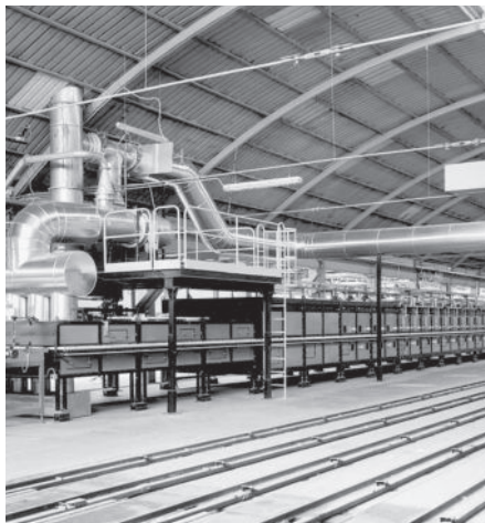
Роликовая печь обжига в керамической промышленности
