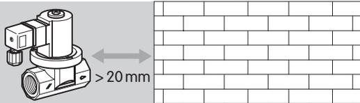
Газовый электромагнитный клапан VGP не должен касаться стен. Минимальное расстояние 20 мм. Не храните и не устанавливайте прибор на открытом воздухе.
