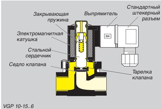
Газовый электромагнитный клапан является нормально закрытым, т.е. закрыт, когда на него не подаётся напряжение.
