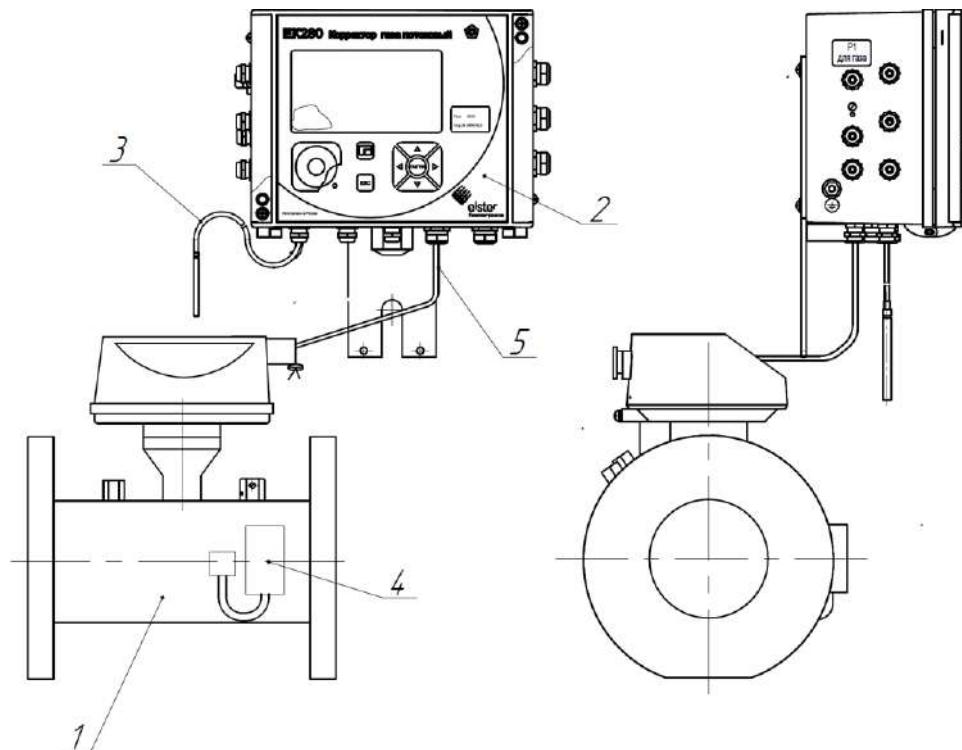
1 - Счетчик газа турбинный СГ
