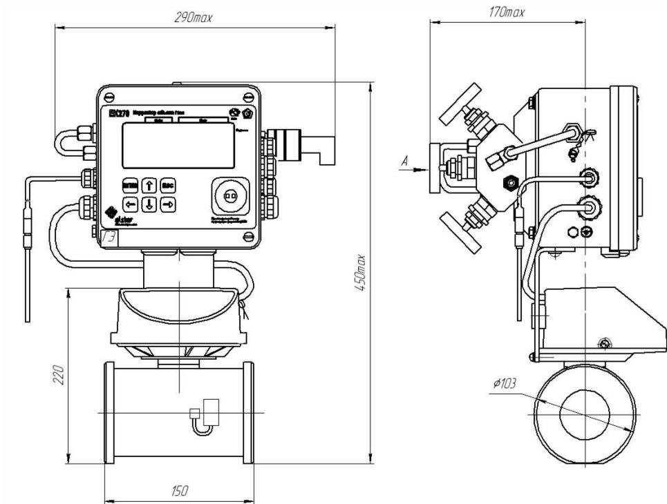
3. СГ-ЭК-Т-100 на базе счетчика СГ с корректором ЕК280
