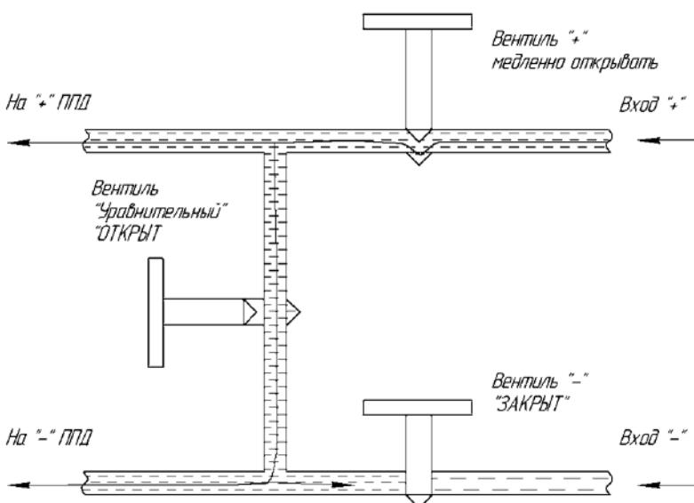
Затем плавно открыть вентиль минусовой камеры, контролируя перепад давления по корректору ЕК270 или ЕК280. Значение перепада давления не должно превышать верхний предел измерения ППД, иначе преобразователь перепада давления может выйти из строя. Испытательное давление не должно превышать максимального рабочего давления преобразователя перепада давления – 1,6 МПа.
