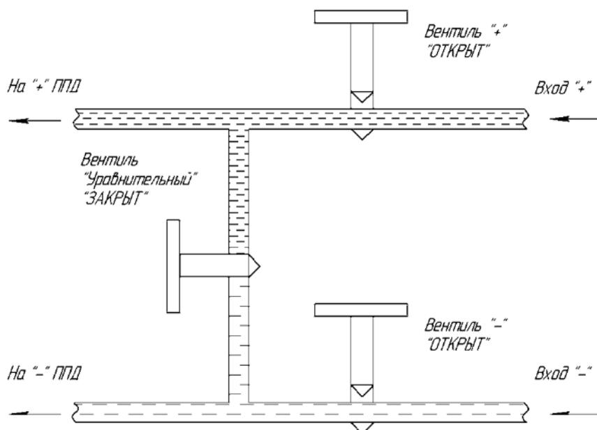
После закрытия уравнительного вентиля проконтролировать перепад давления на счетчике по показаниям корректора ЕК270 или ЕК280.
