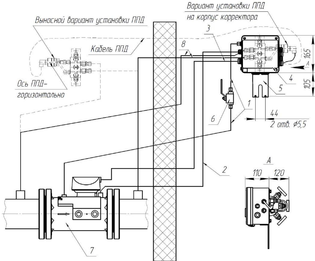
1 - Импульсная трубка преобразователя давления
