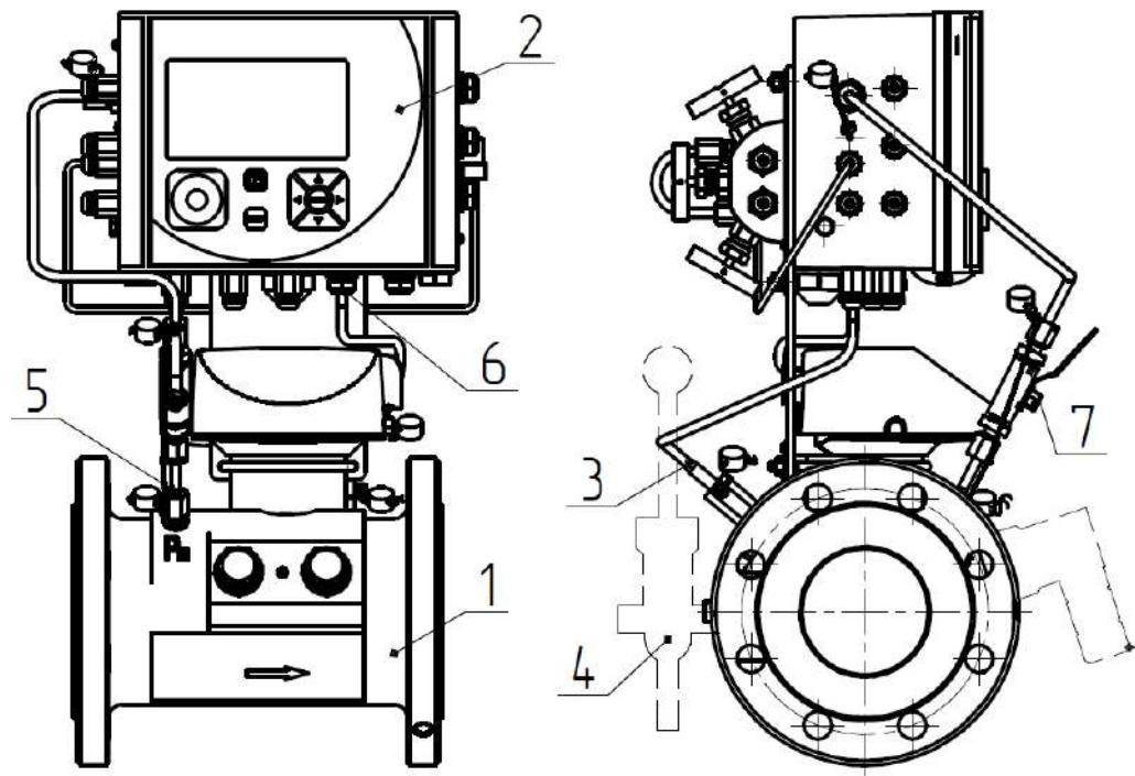
1 - Счетчик газа турбинный TRZ
