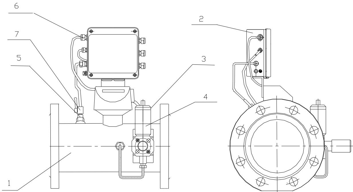
1 - Счетчик газа турбинный СГ
