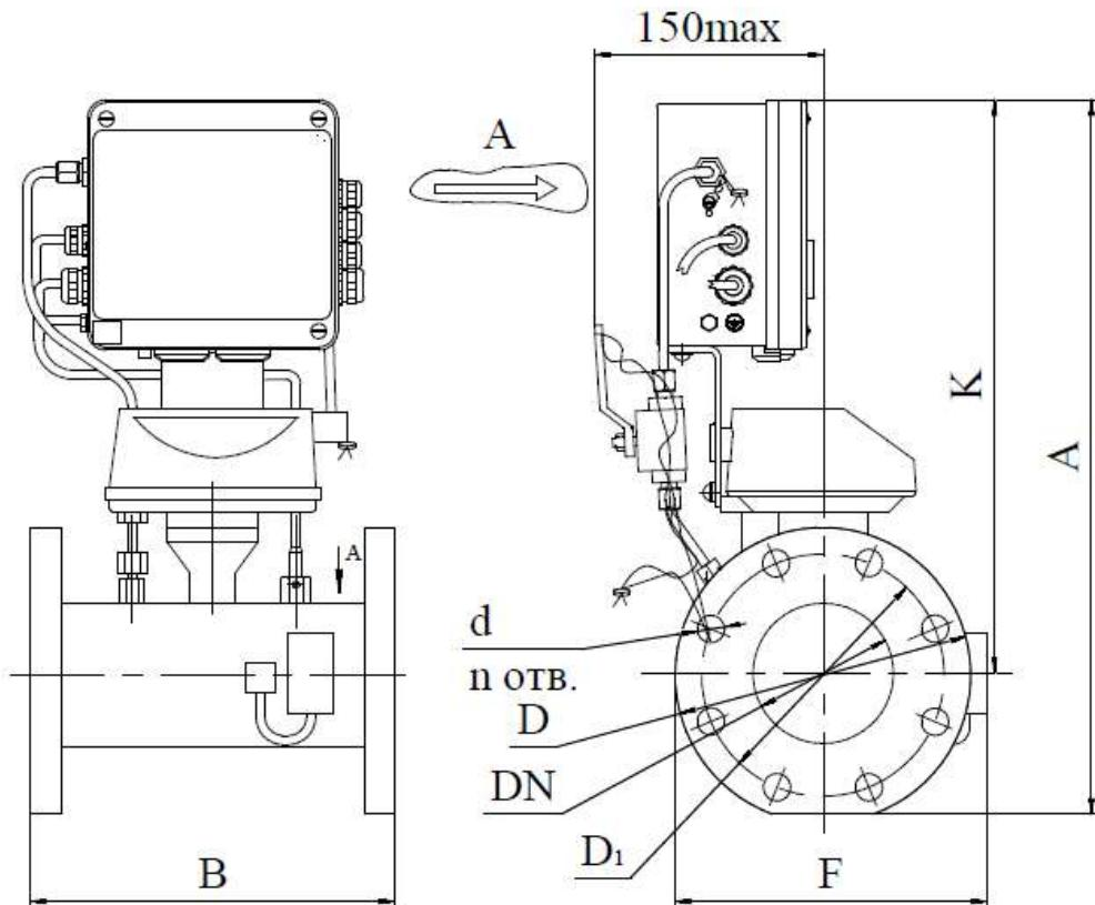
Рисунок 1 Направление потока газа: слева - направо
