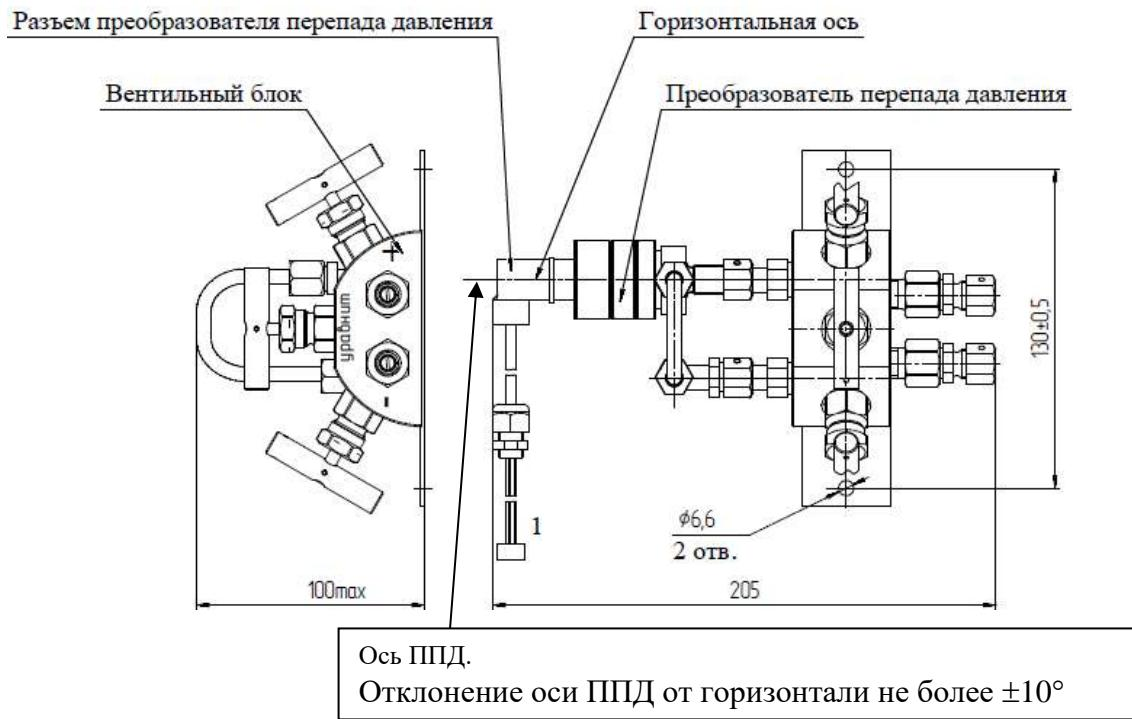
3. Место отбора давления для подключения преобразователя перепада давления на трубопроводе
