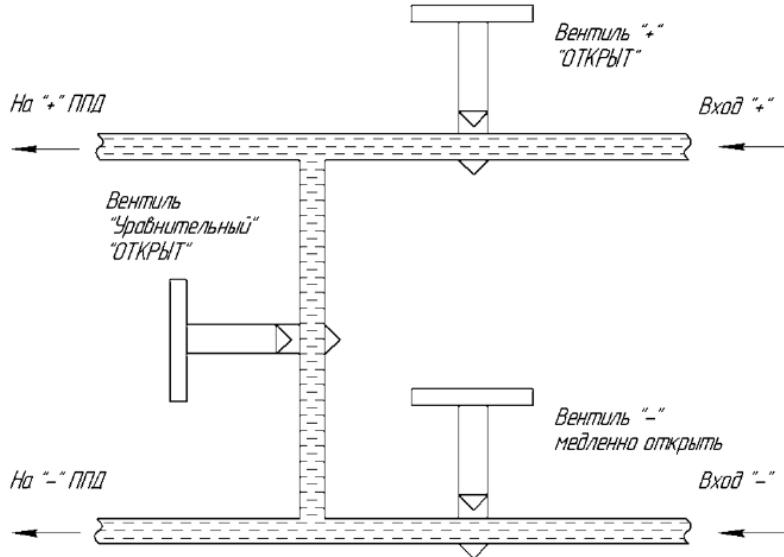
После опрессовки (сброса испытательного давления) закрыть сначала вентиль минусовой камеры, затем вентиль плюсовой камеры, уравнительный вентиль оставить открытym.
