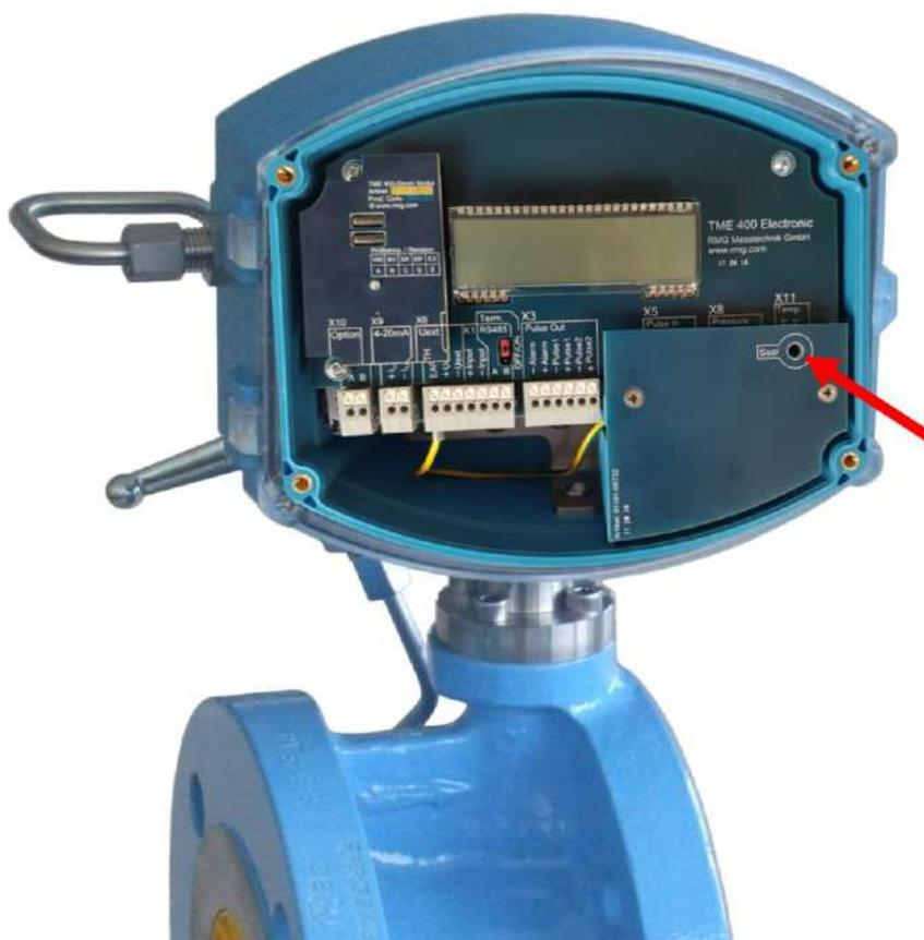
**Рисунок 8: Положение кнопки калибровки**
