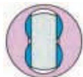
РАЗРЕЗ / CUT WAY Y-Y Соединение вал-шар Stem ball connections
