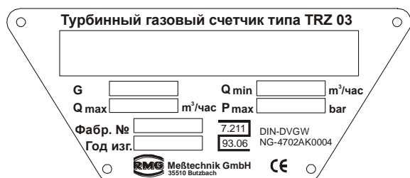
Главная табличка турбинного газового счетчика TRZ 03 со счетной головкой типа „F“
